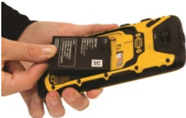
5. Remplacez le couvercle de la batterie et verrouillez-le.
