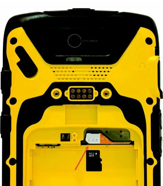
4. Remplacez la batterie et le couvercle de la batterie.
