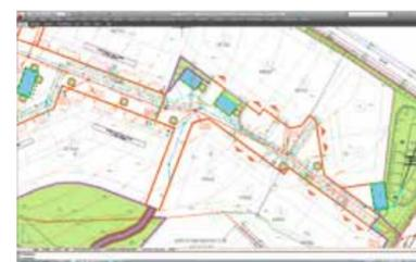
Enfin, la fonction d'expertise permet de détecter tout problème de pose ou de croisement entre les différents réseaux. Ces aléas sont automatiquement représentés sur le profil en long qui est lié, de manière interactive, aux autres vues (vue en plan, profil en long et coupe transversale).
