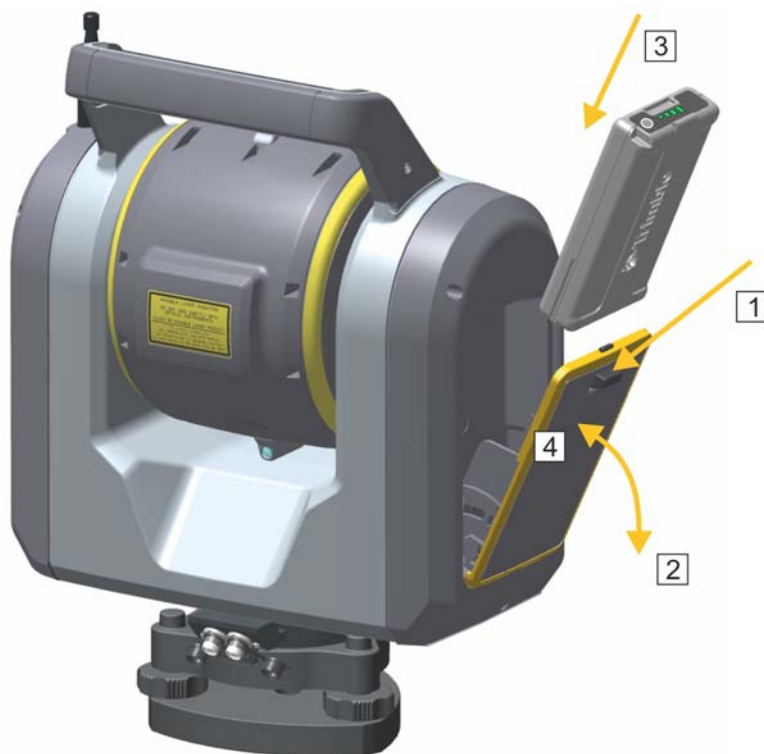
Figure 4.5 Comment insérer et/ou retirer la batterie interne
