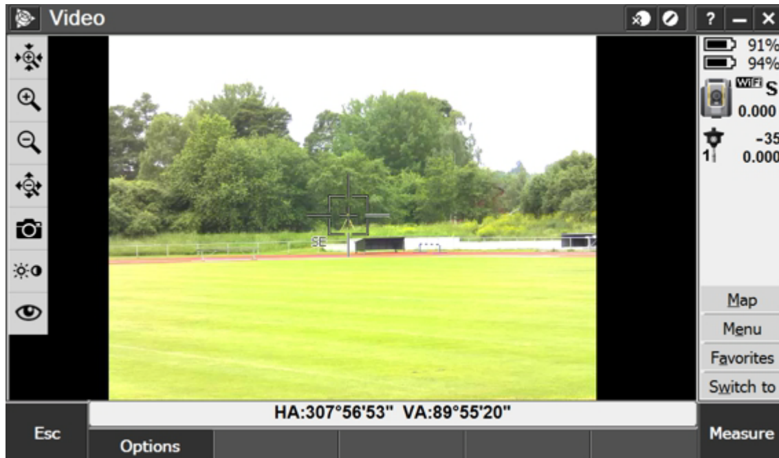
Figure 5.4 Premier niveau de zoom de l'appareil photo principal
