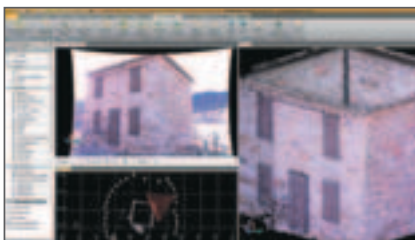
Panorama et nuage de points dérivés de Trimble V10 pour la reconstruction d'une façade.
