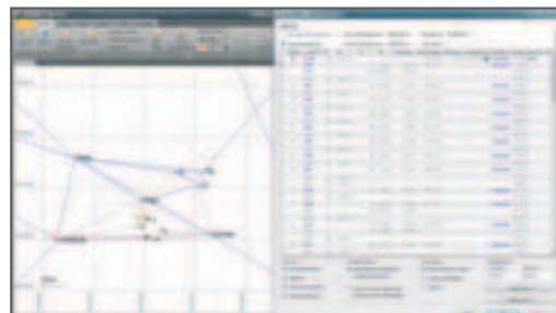
Ajustement des données de niveau et intégration dans le calcul de réseau pour le plan cadastral.
