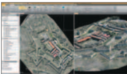
Nuage de points et orthomosaïque dérivés de Trimble UX5 pour la préservation de l'héritage culturel.
