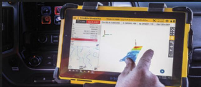
La version **Trimble Siteworks Positioning System pour chefs de chantier ou conducteurs de travaux** comprend l'antenne intelligente SPS986 ou SPS785, une tablette renforcée T7 ou T10 et le logiciel de terrain Siteworks. Cette combinaison permet d'exécuter des progiciels de bureau complets, de travailler facilement avec les données acquises et les modèles 3D sur le terrain sans transporter d'ordinateur portable.
