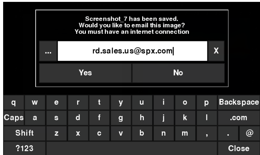
Figure 12-2 : Message s'affichant après avoir appuyé sur la touche Appareil photo pour faire une capture d'écran avec une connexion à un réseau Wi-Fi. L'utilisateur peut saisir l'adresse e-mail devant recevoir le mini rapport.
